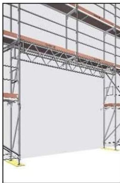
Фиг. 85 Съединяване на фермите
